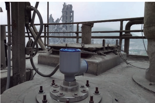
MEDICIÓN DE NIVEL EN SILOS CON ALTA POLUCIÓN
